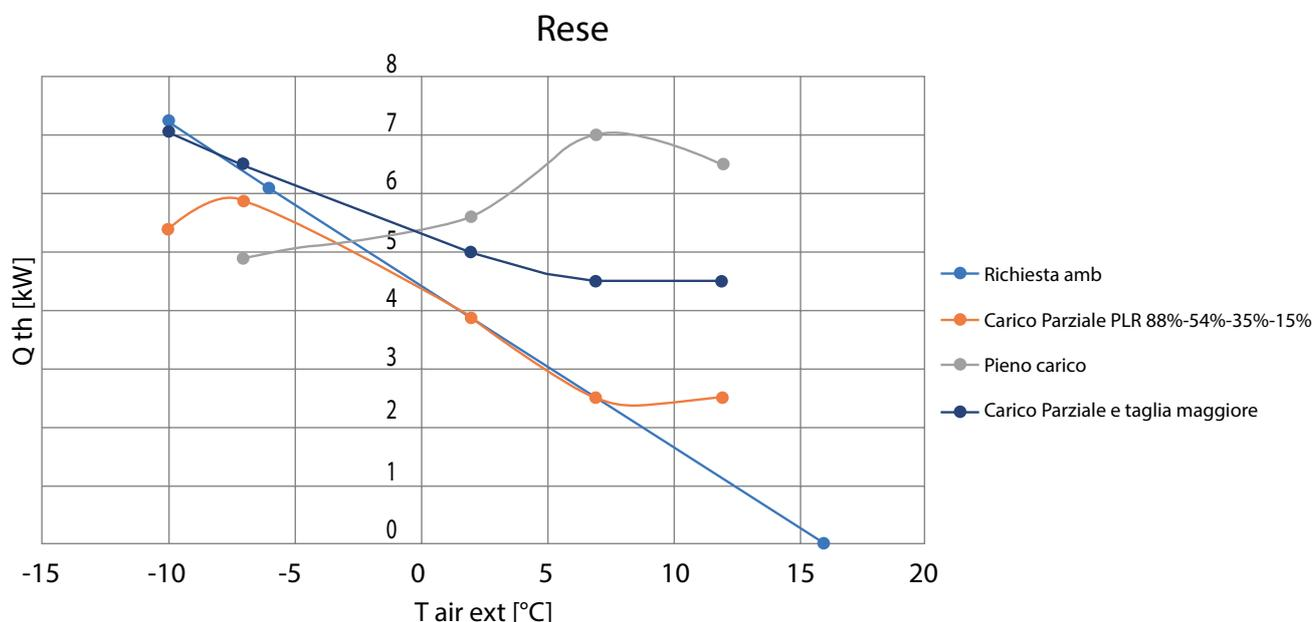
Nell'esempio qui sopra, si vede come la scelta di una macchina di taglia idonea permetta alla stessa di inseguire il carico termico nella maniera migliore, attraverso la modulazione, fino al raggiungimento della minima di modulazione, e quindi di un comportamento di tipo on/off, ad una temperatura esterna elevata (curva arancione).
