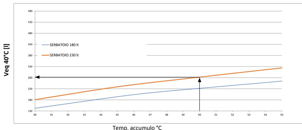
I tempi di ricarica sono anch'essi graficati, e funzione solo della taglia del serbatoio e della temperatura da raggiungere. La potenza della pompa di calore ha una debole influenza sulla capacità di scambio, e di conseguenza è indipendente dalla taglia per generatori della stessa famiglia (per esempio: ERGA 04-06-08).
