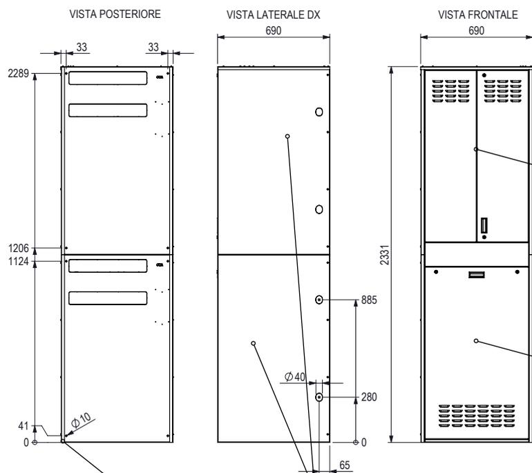
Fori di fissaggio  $\varnothing 10$
